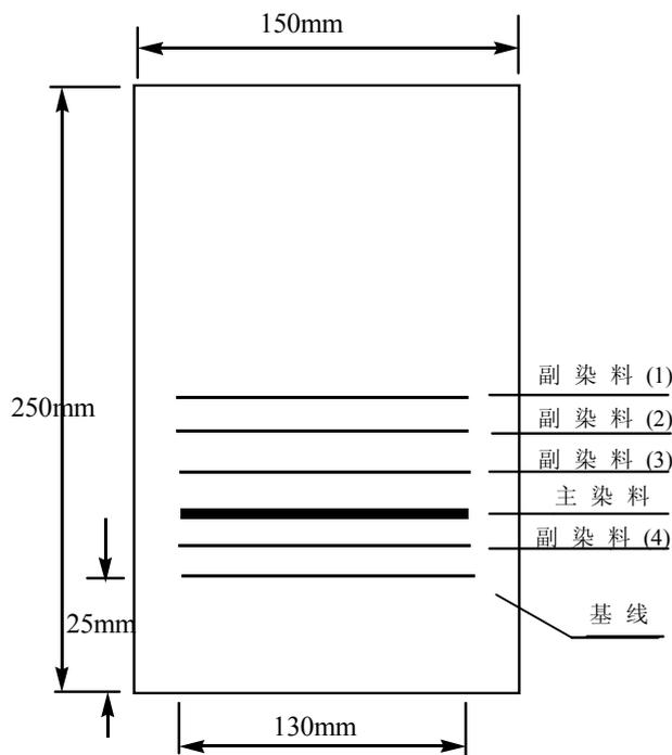
图 A.2 副染料纸上层析示意图
